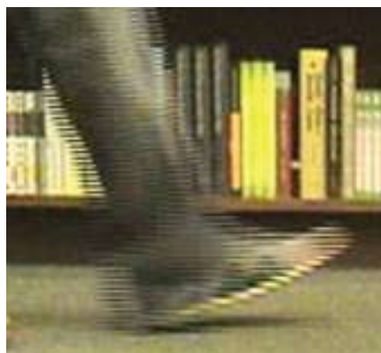
隔行捕获的视频中“梳齿”伪影是由在捕捉两个区域期间某个对象的运动导致的。
